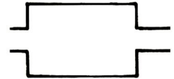
β Δοχείο εκτόνωσης
