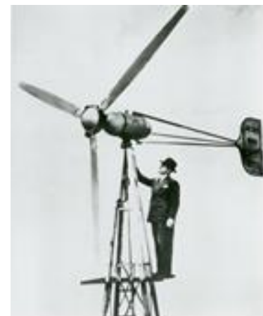
Ο Marcellus Jacobs πάνω σε μία ανεμογεννήτρια 1940-50 (ισχύς ~3 kW)
